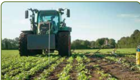
Voor de bodemverdichting is gemeten met boiling tubes. Dat zijn staven met op het eind een flexibel siliconendeel, waarbij de staven gevuld zijn met vloeistof.
