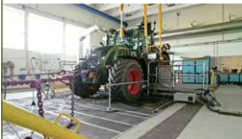
De transporttest is uitgevoerd op de DLG-rollentestbank volgens de Powermix-metingen waarbij transportbelastingen nauwkeurig worden gesimuleerd volgens vaste protocollen.
